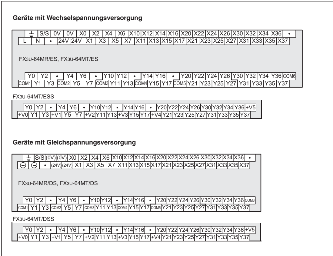
Abb. 4-10: Klemmenbelegung der Grundgeräte FX3U-64M□
